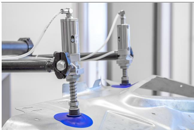
Bielas elásticas FST-LOCK-HD durante la manipulación de una pieza de automóvil
